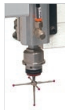
Tastatore a 5 sonde consente di rilevare con la massima precisione le dimensioni del pannello.
